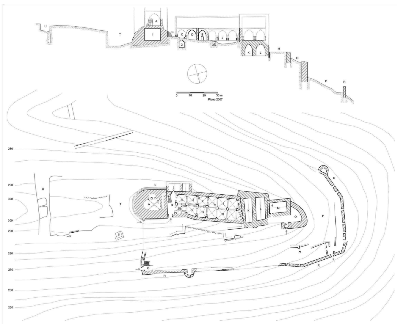
Abb. 3: Übersichtsplan der Burg (nach den Vermessungen von Pinkerfeld 1955, Frankel 1986 und eigenen Aufnahmen), unten Grundriss (Gebäude jeweils auf Grundebene; ohne Scheidung von Bauphasen), oben Längsschnitt: A – Frontturm, B – Vorraum, C bis H – Kompartimente im Untergeschoss des Saalbaus, K und L – Hallen im Unterbau des Wohnturms, M – Anbau mit Zisterne, N – Torturm, O – Torzwinger, P – Unterburg, Q – äußeres Burgtor; R – äußere Ringmauer, S – Sockel des Frontturms, T – westlicher Halsgraben, U – östlicher Halsgraben; 1 bis 5 – Zisternen
